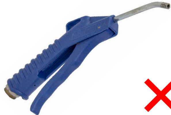
Manipulierte (abgesägte) Blaspistole
