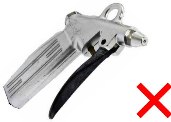
Pistolet de soufflage avec buse monotrou bruyante (>3.5 bars)
