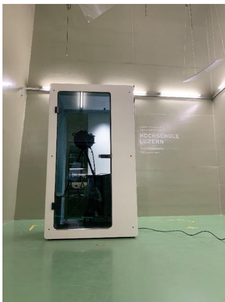
Abbildung 4: Aufbau mit Prüfobjekt Chatpod
