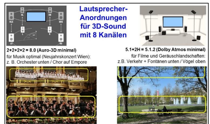
Abbildung 1: Lautsprecher-Anordnungen für die 3D-Wiedergabe: Auro-3D bzw. Dolby Atmos (-2) / Telarc
