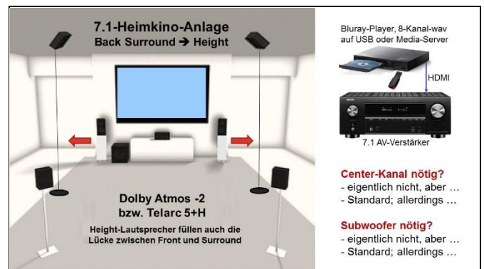
Abbildung 2: Lautsprecheranordnung Dolby Atmos mit 2 Deckenlautsprechern bzw. Telarc 5+H, mögliche Umsetzung
